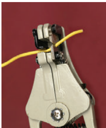
Рис. 2.19. Использование автоматического инструмента для удаления изоляции, когда вы сжимаете рукоятки, губки слева зажимают провод, а острые лезвия с вырезами справа надкусывают изоляцию. Увеличение сжатия приводит к тому, что губки и лезвия отходят друг от друга, снимая изоляцию с провода
