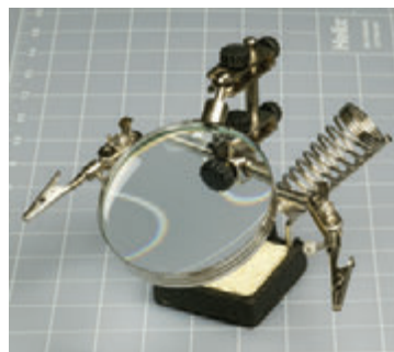
Рис. 3.3. Держатель оснащен двумя «крокодилами» для фиксации вашего изделия. Металлическая спираль — это держатель для фиксации вашего разогретого паяльника, а губка предназначена для очистки его жала
