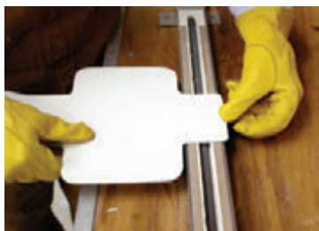
Рис. 5.85. Выполнение чистых точных изгибов АБС-пластика это просто не-большое по времени пребывание пластика на гибочном устройстве, которое состоит практически из одного электрического нагревательного элемента
