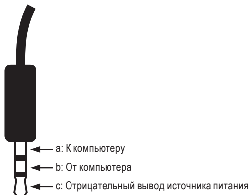
Рис. 5.134. Вилка стереоразъема на конце USB-кабеля для загрузки программы может быть использована для проверки правильности работы программы. Мультиметр должен быть установлен в режим измерения постоянного напряжения и должен быть подключен к точкам «b» и «с» вилки, чтобы проверить посылает ли программа Programming Editor данные через порт при последовательной передаче данных
