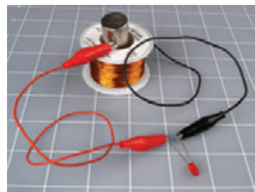
Рис. 5.21. При энергичном перемещении магнита вверх и вниз через отверстие в центре катушки вы генерируете необходимое количество электроэнергии, которой будет достаточно для загорания светодиода
