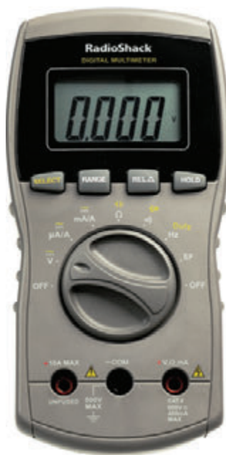
Рис. 1.6. Мультиметр RadioShack из среднего ценового диапазона, который имеет все основные функции; однако имеется двойное назначение каждой позиции дискового переключателя, уточняемое с помощью кнопки SELECT, что, безусловно, приводит к некоторым трудностям. Тем не менее этот прибор имеет автоматическое определение диапазона измерения
