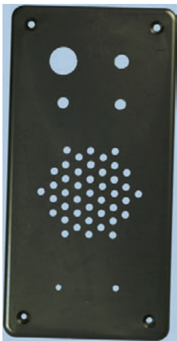
Рис. 3.87. Наружная часть передней панели после выполнения отверстий. Небольшая беспроводная дрель идеально справится с этой работой, если аккуратно была сделана разметка отверстий
