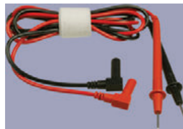
Рис. 1.17. Вилка черного измерительного щупа вставляется в общее гнездо «COM» (Common), а вилка красного — в гнездо, которое обычно является самым правым гнездом мультиметра
