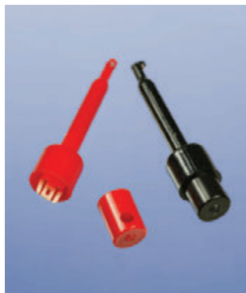
Рис. 3.8. Затем другой конец провода вставьте в боковое отверстие снятого пластмассового колпачка клипсы. Защищенный конец провода нужно припаять к контактам клипсы. После этого завинтите колпачок клипсы
