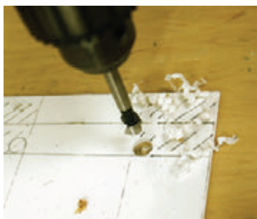
Рис. 5.84. Высверливание отверстий в любом месте, где есть пересечение двух изгибов, уменьшает риск растрескивания пластика
