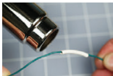
Рис. 3.43. С помощью промышленного фена начните разогрев трубки
