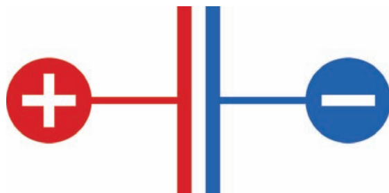
Рис. 2.63. Когда постоянное напряжение достигает конденсатора, по нему ток не протекает, но конденсатор заряжается, как маленькая батарейка. Положительный и отрицательный заряды на конденсаторе будут равны и противоположны по знаку
