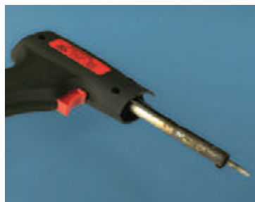
Рис. 3.2. Этот паяльник достаточно большой мощности создает дополнительный разогрев, который необходим для пайки толстых проводов и компонентов большого размера. При постоянном использовании паяльника он со временем теряет свой первоначальный вид, что никоим образом не сказывается на его эксплуатационных характеристиках, если поддерживать его жало в чистом состоянии
