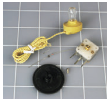
Рис. 5.59. К всему этому просто добавьте провод и катушку и это будет все, что нужно для приема сигналов АМ-радио. Черный диск становится регулятором настройки после того, как он будет прикреплен к переменному конденсатору (справа). Это на самом деле избыточная добавка. Германиевый диод (в центре) осуществляет выпрямление радиосигнала. Наушник с большим значением сопротивления (в верхней части рисунка, желтого цвета) создает хорошо различимый на слух звук
