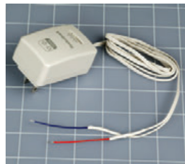
Рис. 3.45. Одножильные провода разного цвета, припаянные к проводам сетевого адаптера, для удобной подачи напряжения на макетную плату. Следует помнить, что они имеют разную длину, чтобы уменьшить риск касания друга в месте соединения
