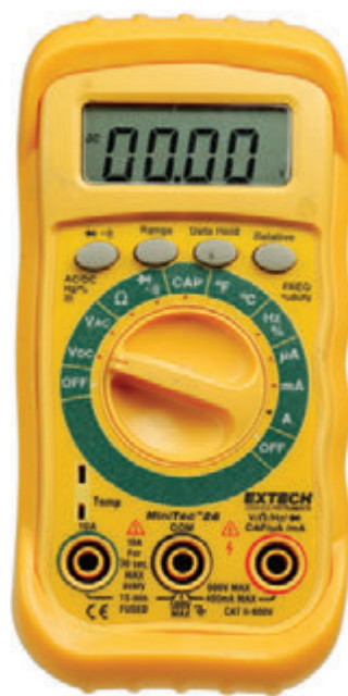
Рис. 1.7. Мультиметр, произведенный компанией Extech, имеет автоматическое определение диапазона измерения, обладает всеми основными функциями. Кроме того, в приборе имеется датчик температуры, который может быть полезен для определения температуры разогрева некоторых компонентов, например блоков питания
