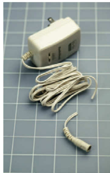
Рис. 2.46. Подготовка сетевого адаптера. Сначала надо отрезать низковольтный выходной разъем и отправить его в мусорную корзину
