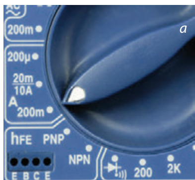
Рис. 1.52. Мультиметр с ручным выбором режима измерения такой, например, как приведенный здесь, при измерении тока в миллиамперах требует от вас переключения красного измерительного щупа в другое гнездо прибора. В большинстве современных мультиметров этого делать не нужно до тех пор, пока вам не понадобится измерять большие значения токов
