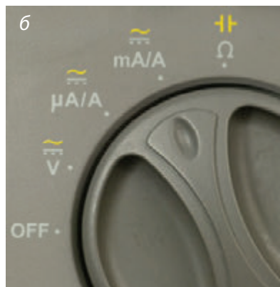
Рис. 1.51. Если вы попытаетесь измерить слишком большой ток, то в любом приборе обязательно должен сгореть внутренний предохранитель. В нашей цепи нет никакого риска, если вы установите регулятор потенциометра в среднее положение. Для измерения силы тока в миллиамперах выберите режим «mA» и запомните, что мультиметр при этом будет отображать значения, которые означают тысячные доли ампер
