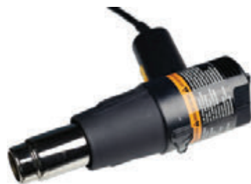
Рис. 3.9. Похожий на мощный фен для волос промышленный фен используется для теплового воздействия на термоусадочную трубку, за счет которой создается прочная изолированная оболочка вокруг оголенного провода
