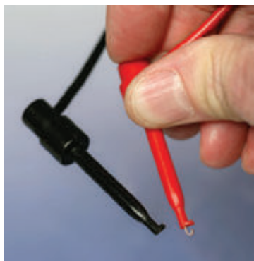
Рис. 3.6. Эти клипсы (мини-захваты) измерительных проводов мультиметра значительно упрощают процесс измерения. Нажатие подпружиненной кнопки клипсы будет приводить к выдвиганию небольшого медного контактирующего крючка. После подключения им к оголенному выводу или проводу надо отпустить кнопку. После этого руки освобождаются для выполнения других задач. Для меня это какая-то загадка, почему мультиметры изначально не поставляются с измерительными проводами с этими клипсами в качестве стандартного оборудования
