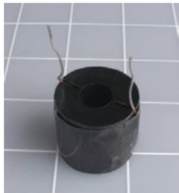
Рис. 5.45. Какие экзотические компоненты можно обнаружить внутри этого суперсовременного аудиокompонента, который используется в сабвуфере для задерживания высоких частот?
