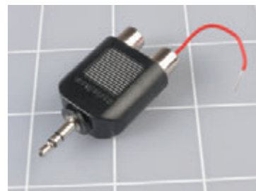
Рис. 5.42. Чтобы подключить выходной сигнал с гнезда наушников музыкального плеера, вы можете использовать данный адаптер и вставить зачищенный конец провода в одно из гнезд. Затем следует использовать «крокодилы», чтобы подключить аудиосигнал к вашей макетной плате. Не забудьте применить дополнительный навесной провод для соединения общего контакта адаптера с минусовым выводом источника питания вашей макетной платы. Поскольку мы использовали только один динамик, то усилитель должен быть подключен только к одному стереовыходу вашего плеера. Другой выход игнорируется
