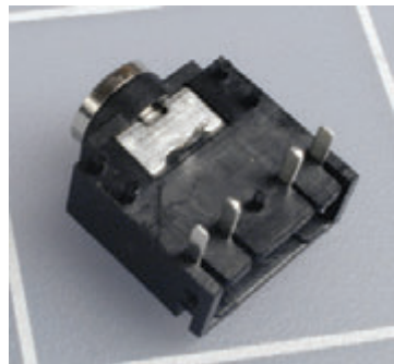
Рис. 5.125. Общий вид гнезда 3,5-мм, которое используется вместе с интерфейсным USB-кабелем для программирования микроконтроллера
