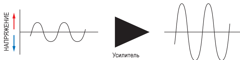
Рис. 5.31. Третий шаг процесса: небольшие по мощности сигналы микрофона проходят через усилитель, который увеличивает их амплитуду, сохраняя частоту и внешний вид волновой формы
