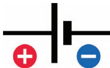
Рис. 2.41. Символ для графического обозначения батарейки обычно показывают без символов «+» и «-». Я же их привожу для ясности и однозначного толкования
